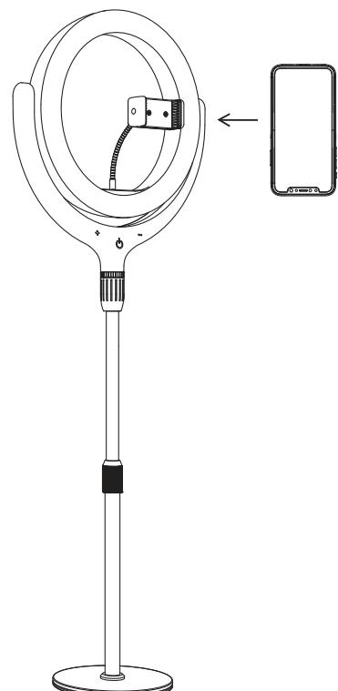
**Schritt 3:** Den flexiblen Arm (2) in die Ringleuchte (1) einsetzen. Die Smartphone-Halterung (10) in das Kugelgelenk des Flexiblen Arms (2) drücken.
