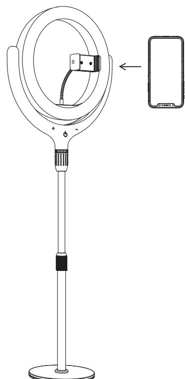
**Stap 3:** Steek de flexibele arm (2) in de ringverlichting (1). Druk de smartphonehouder (10) in het kogelgewicht van de flexibele arm (2).
