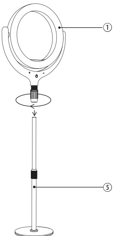
**Schritt 1:** Den Ständer (5) in den Montagefuß (7) schrauben.
